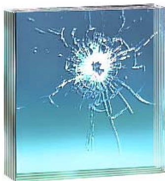
Рис. 1.2.12. Стекло, армированное несколькими слоями полимерных пленок
