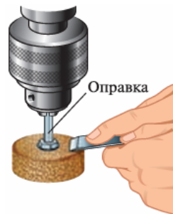
Рис. 11.10. Рабочий момент доводки режущего инструмента
