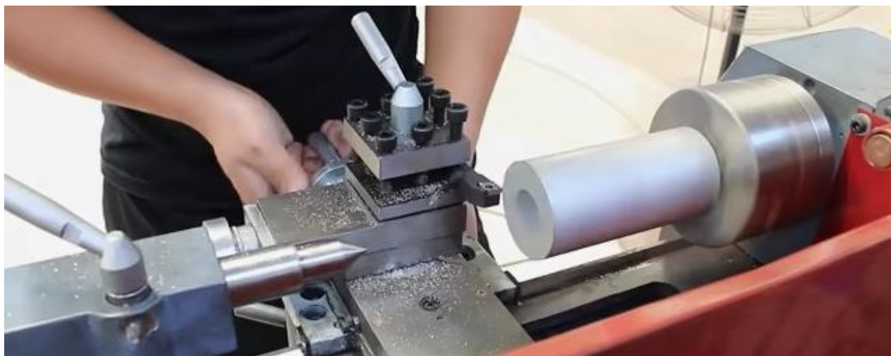
Обтачивание цилиндрических поверхностей
