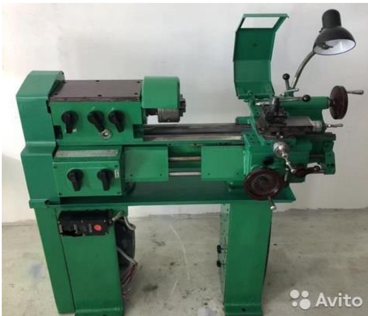
Общий вид токарно-винторезного станка ТВ-6
