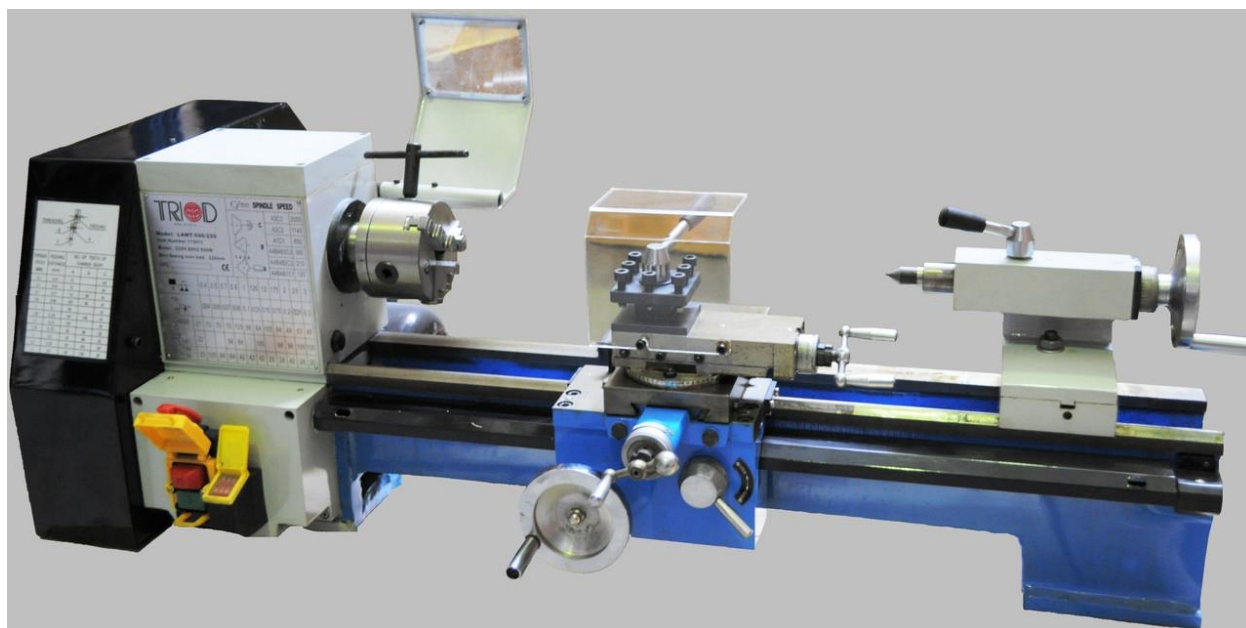
Общий вид универсального токарного станка TRIOD Model: LAMT-700P/400
